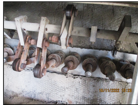
ภาพที่ 3.84 Casing ฝุ่นชุด Hammering Equipment ในหม้อไอน้ำ
