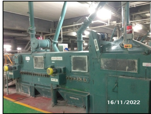
ภาพที่ 3.66 หลังคาปิดคลุมเครื่องจักรจ่ายปูนซีเมนต์
