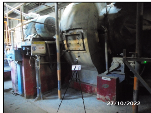
ภาพที่ 3.75 การตรวจวัดระดับเสียงของ เครื่องจักรบริเวณ Cooler
