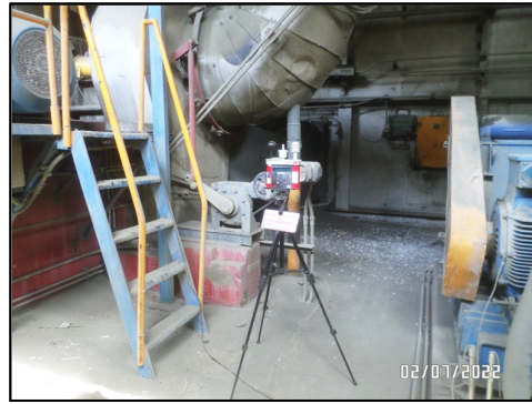
ภาพที่ 3.97 การตรวจวัดความร้อน บริเวณช้างพัดลม Cooler 5
